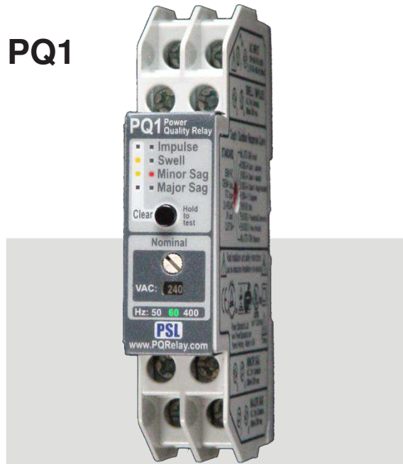
Der kompakte Netzqualitäts-Monitor lässt sich schnell in jedes System integrieren. Einbau auf Hutschiene oder in die Frontplatte – Spannung anklemmen, Nennspannung einstellen und den gewünschten Standard auswählen – fertig.
